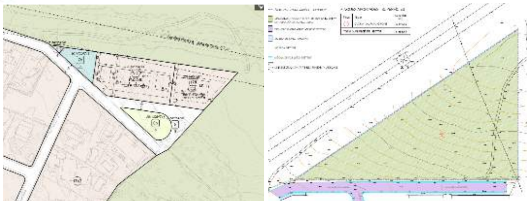
PLÀNOL DEL REFÓS D'AMB I PLÀNOL DEL PLA PARCIAL, AMB DELIMITACIÓ DE LES AFECTACIONS DE LA LÍNIA D'ALTA TENSIÓ CLARAMENT PARAL·LELA AL LÍMIT NORD DE L'ÀMBIT
